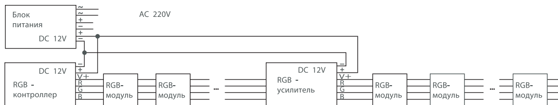
Схема 1. Последовательное подключение. Блок питания 1шт
